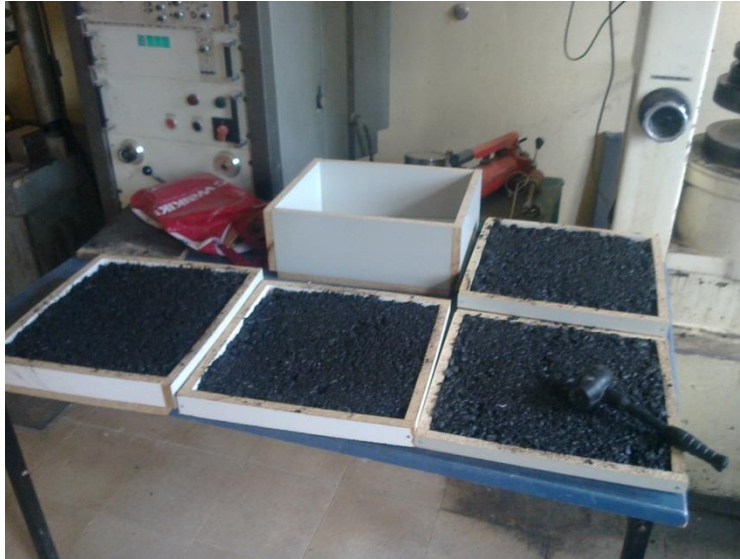
Şekil 4. Sıkıştırılma işlemleri sonrası soğumaya bırakılan karışımlar
